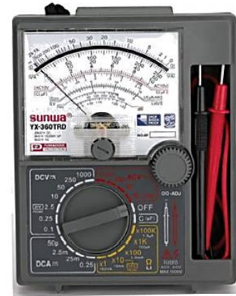
รูปที่ 1.11 แสดงสัญลักษณ์ต่างๆ บนสเกลหน้าปัดของเครื่องวัดไฟฟ้า
